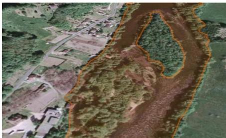
Figure 3 : Exemple de délimitation du DPF. Le domaine englobe le lit courant de la rivière, un vaste atterrissement boisé ainsi qu'une frange de terrains bas boisés le long de la berge (notamment en haut à droite sur la photo). Il exclut une île dont l'altitude est plus haute que la berge où ont lieu les premiers débordements.
